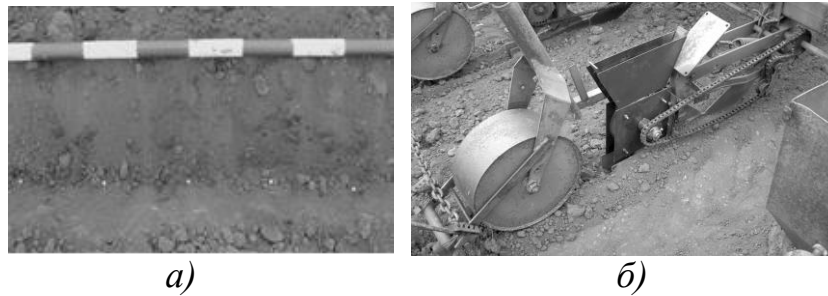
Рис. 8. Сівба насіння кісточок черешні макетним зразком висівного апарату точного висіву у складі сівалки ССК-4 в агрегаті з трактором МТЗ-82: а) кісточки черешні в борозні; б) загальний вигляд висівного апарата.
