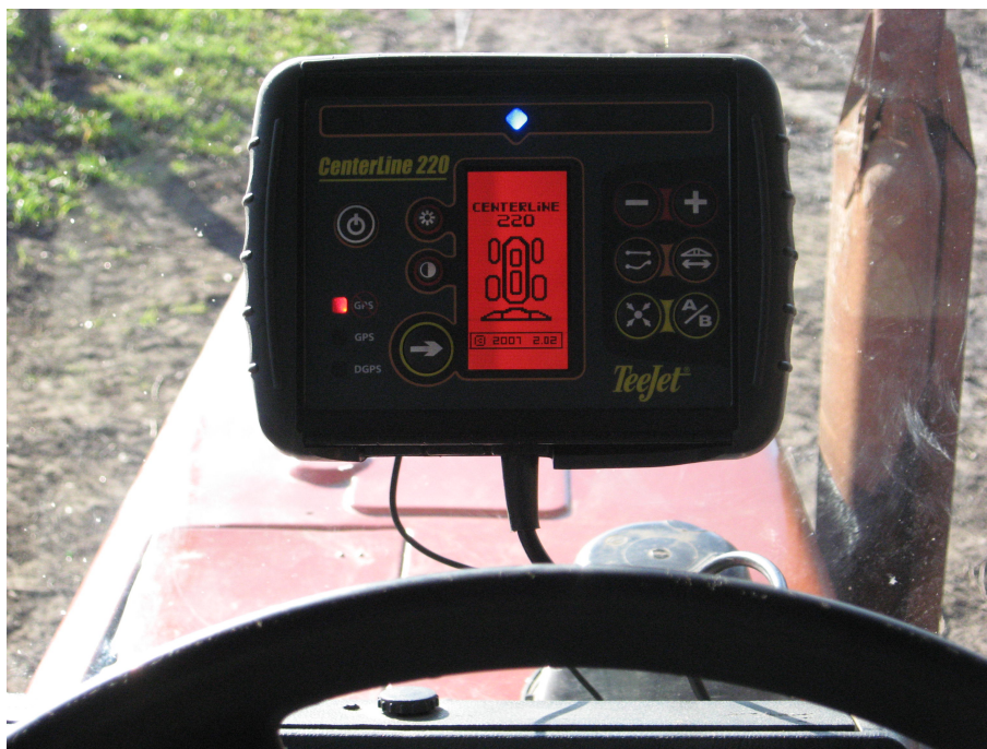
Рис. 4.9 – Кабіна трактора, обладнана GPS-навігатором
