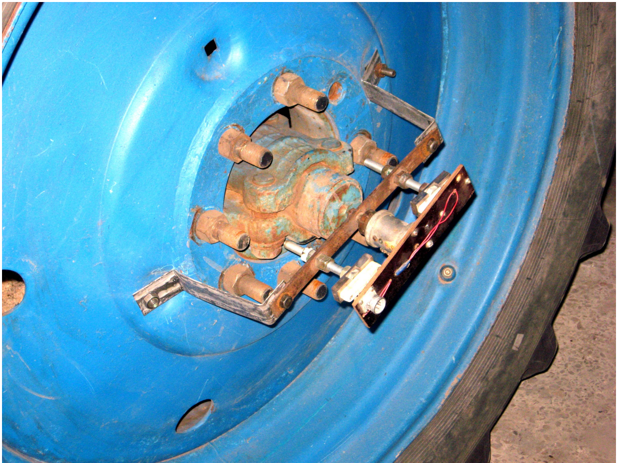
Рис. 3.7 – Установка струмознімача датчика обертів заднього колеса трактора МТЗ-80
