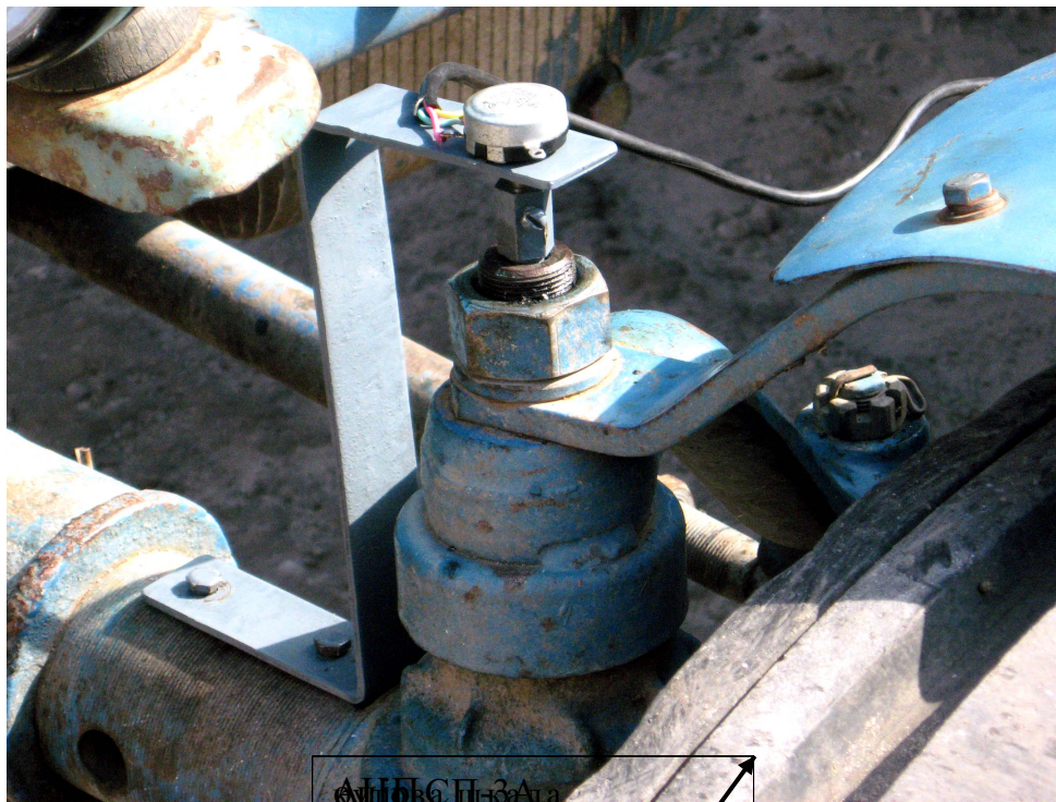
Рис. 3.4 – Установка датчика СП-3А для запису кута повороту керованого колеса трактора
