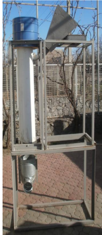
Рис. 12. Загальний вид експериментального пневмогравітаційного сепаратора
