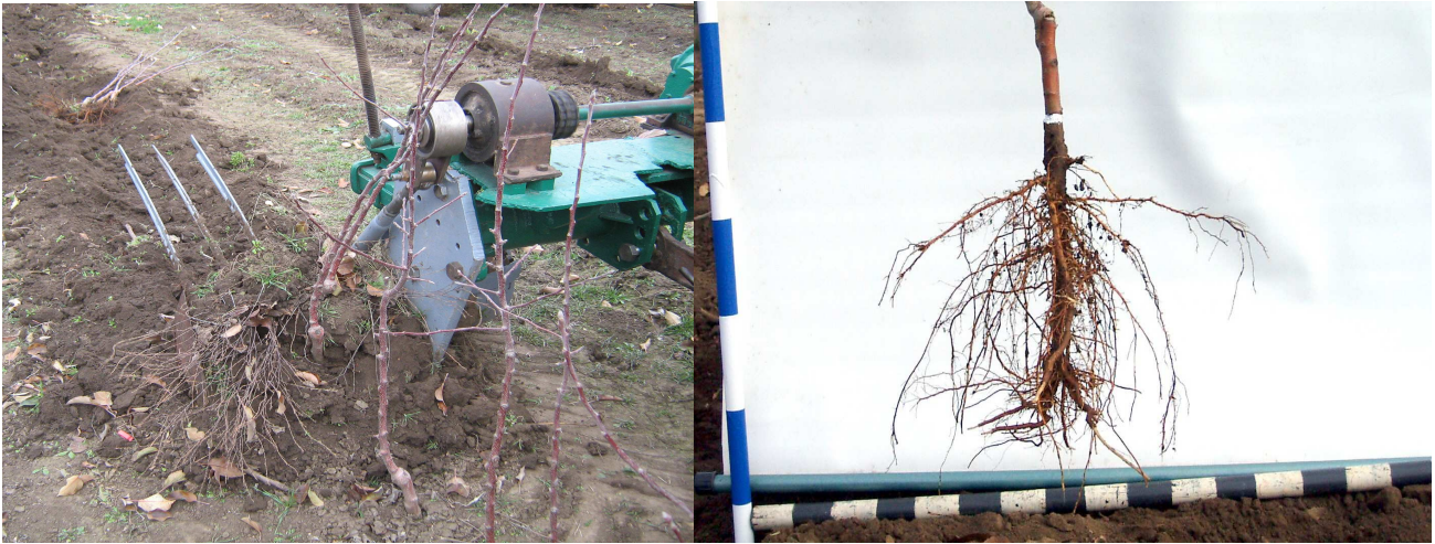
Рис. 18. Викопування саджанців черешні плугом ВПН – 2М з експериментальним робочим органом.
