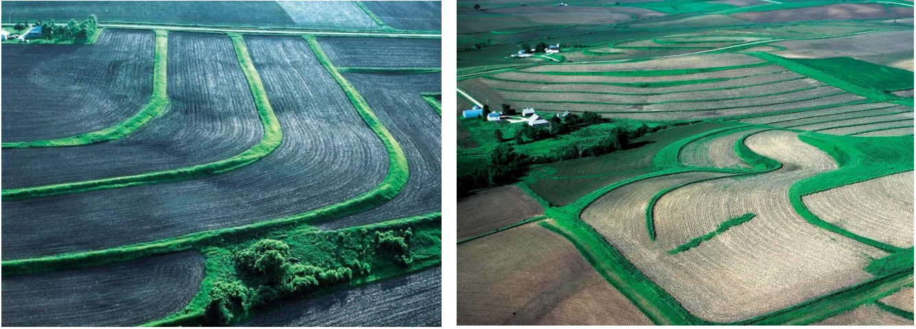
Рис. 1.1 Приклади терасування схилів (фото USDA Natural Resources Conservation Service)
