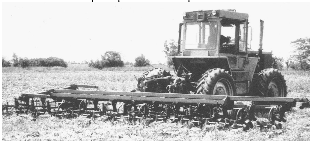
Рис.10. Трактор ХТЗ-120 в агрегаті з культиватором КРН-8,4
