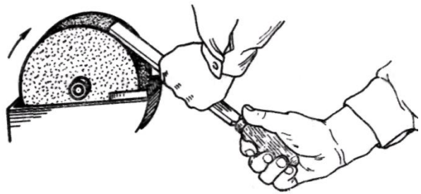
Рис. 13.4. Загострювання плоского шабера: а — торця; б — грані; в — кромки.
