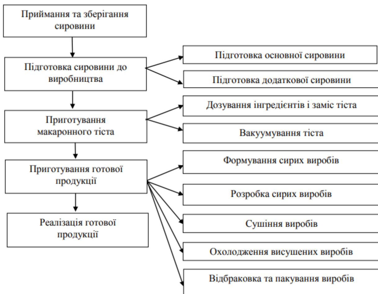
Рис. 4.1. Принципова технологічна схема виробництва інноваційних макаронних виробів
