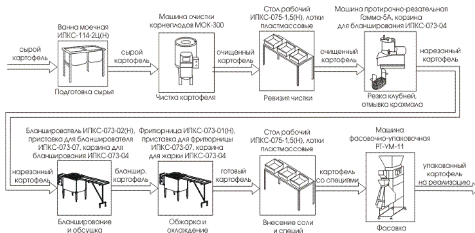
Рисунок 2.1 - Технологічна схема виробництва чіпсів.
