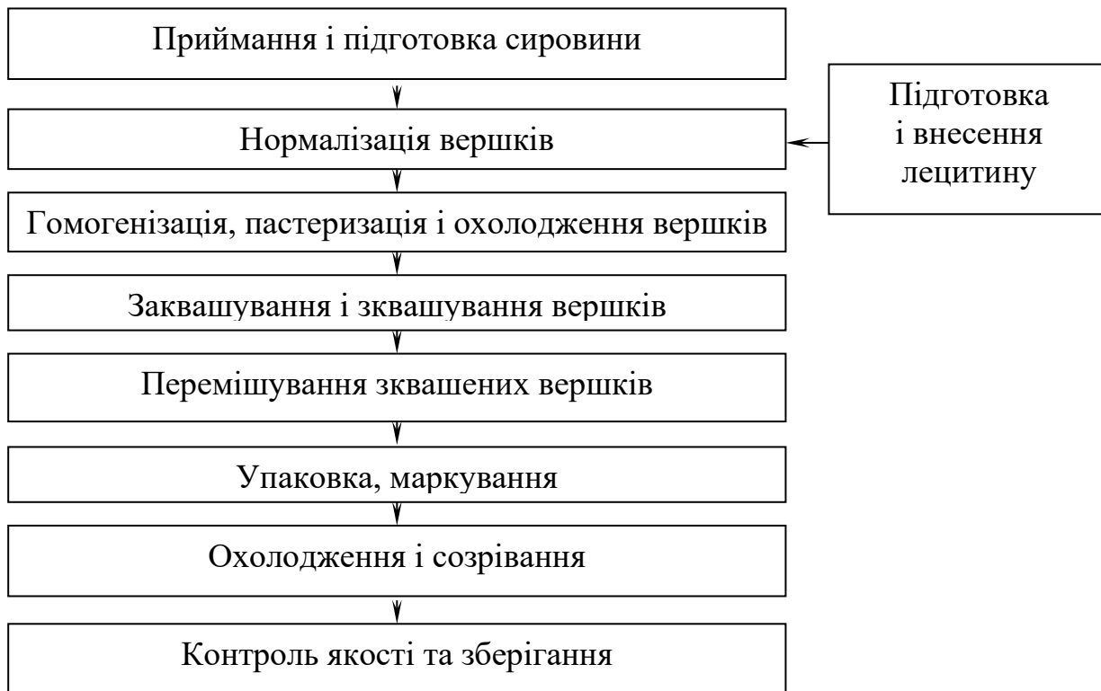
Рисунок 2.2 - Поліпшена технологія виробництва сметани.
