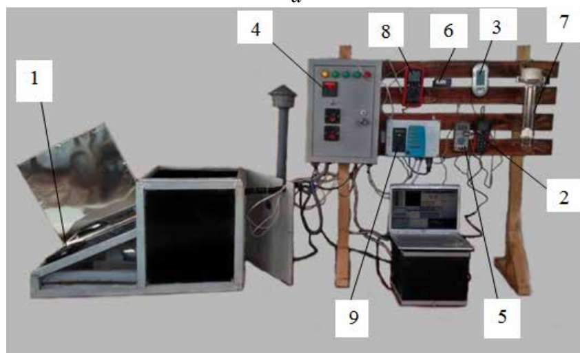
Рис. 1. Конструктивно-технологічна схема геліосушарки з тепловим акумулятором (а) та плоский дзеркальний концентратор і загальний вигляд дослідної установки (б):
