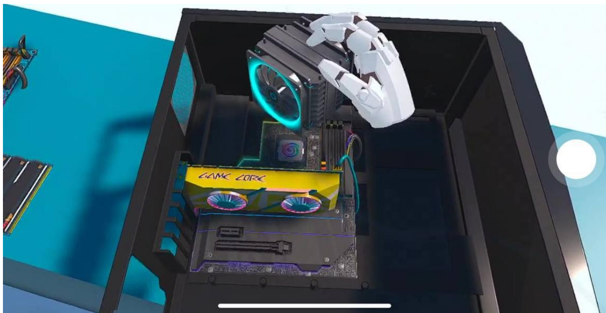
Рисунок 4.28 - Встановлення башти охолодження на материнську плату
