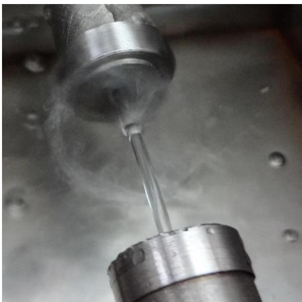
Рис. 6. Процес змішування у протитечійному змішувачі.
