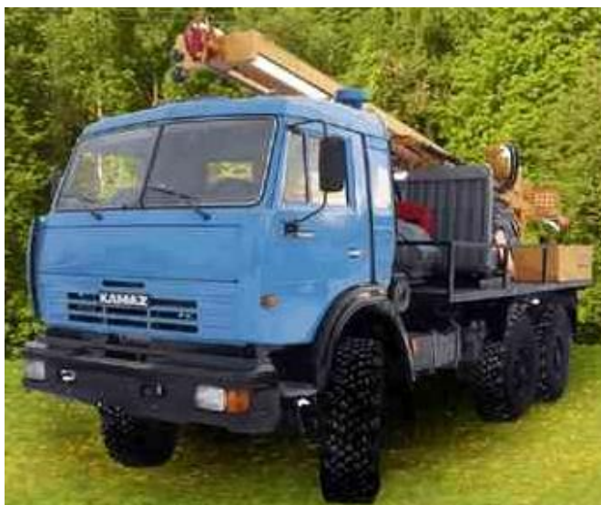
Рис. 1.6. Буровая установка УРБ 2А2
