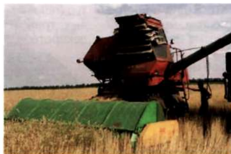
Рис. 7. Жатки «Спринтер-6», навешенные на различные комбайны
