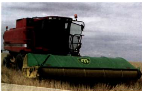
Рис. 7. Жатки «Спринтер-6», навешенные на различные комбайны
