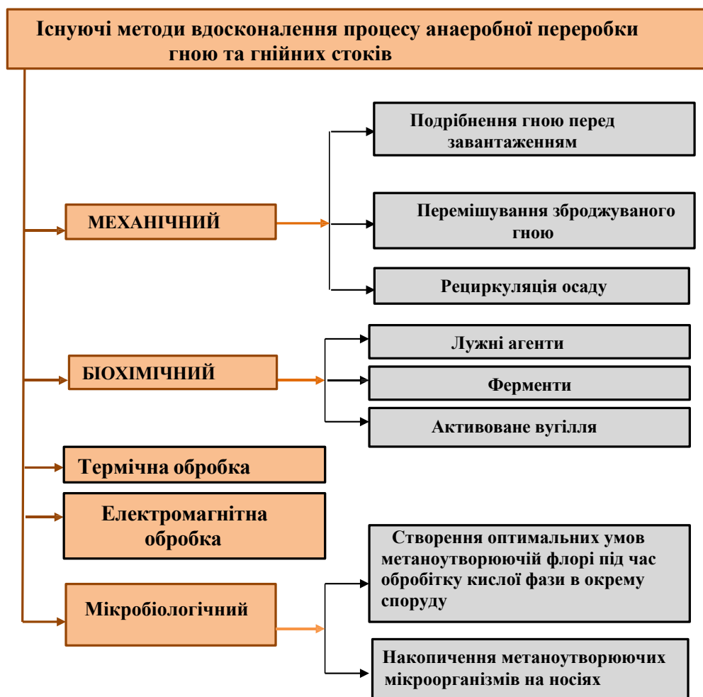
Рис. 1. Існуючі методи вдосконалення процесу анаеробної переробки гною та гнойових стоків
