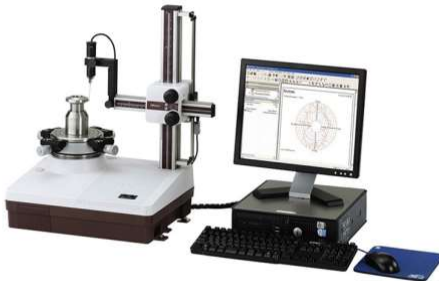
Рис. 2.21. Контроль хвилястості кругломіром
