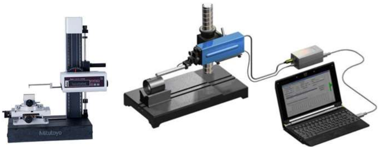
Рис. 2.20. Прилади контактних методів: профілометр і профілограф
