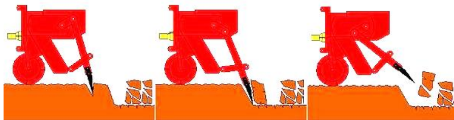
Рис. 1. Схема копача з коливальним рухом робочих органів (VANGATRICI, Італія) (16)
