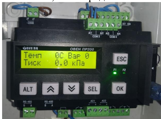
Рис. 2. Загальний вид програмованого логічного контролера ОВЕН ПР200, який використано для автоматизації електричного автоклава малої потужності.
