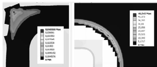
Рис. 7. Распределение контактных давлений (МПа) в сопряжениях нижней базовой плиты с пакетом (слева) и подштамповой плитой прессы (справа)
