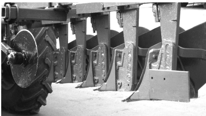
Рис. 4. Вигляд плуга із польовою дошкою, яка закріплена тільки на його останньому корпусі
