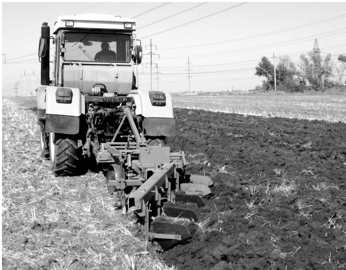
Рис. 5. Орний машинно-тракторний агрегат на основі трактора ХТЗ-170 із шинами 16,9×38 під час проведення польових експериментальних досліджень
