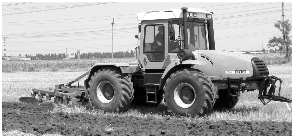
Рис. 6. Орний машинно-тракторний агрегат на основі агрегатуючого колісного трактора ХТЗ-170, обладнаного пневматичними шинами 23,1R26
