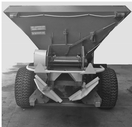
Рис. 1. Машина для розсіювання мінеральних добрив, обладнана двома відцентровими робочими органами, що напрямлені до горизонту (вигляд ззаду)
