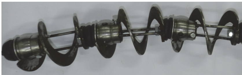
Рис. 1. Конструктивна схема (а) та загальний вигляд (б) гвинтового секційного шарнірного робочого органу для транспортування зерна
