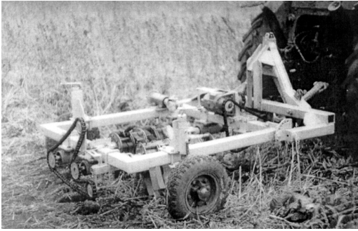
Рис. 2. Загальний вигляд експериментальної установки із двоваловим очисником головок коренеплодів від залишків гички
