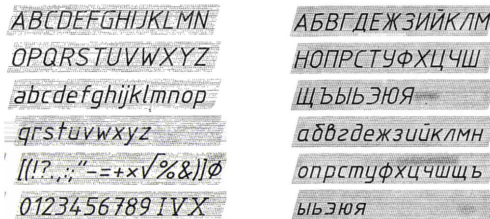
Рис. 6. Ілюстрація шрифтів латинської та кириличної російської абетки, цифр та знаків у національному стандарті ДСТУ ISO 3098-6:2007
