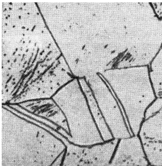
Рисунок 5.3 - Мікроструктура деформованої та відпаленої міді \times 200
