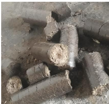
а) брикет при температурі 114°С б) брикет при температурі 84°С
