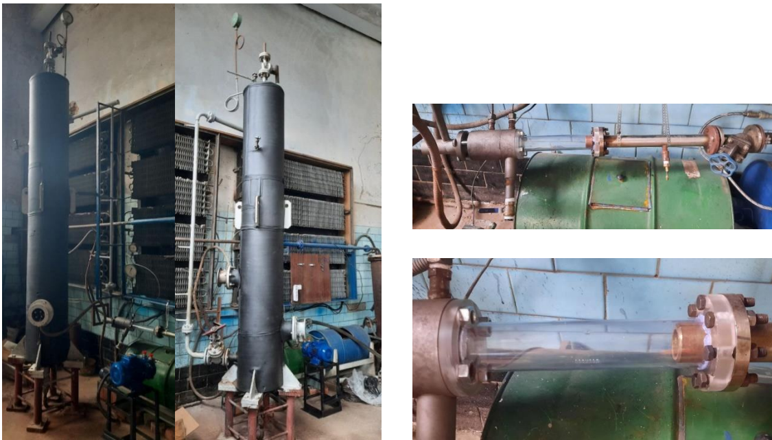
Рис. 2. Фотографії експериментального стану для дослідження характеристик камер змішування РПСА
