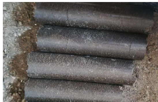
а) брикет при температурі 114°С б) брикет при температурі 84°С
