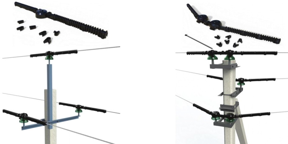
Рис. 6. Птахозахисні пристрої ізолюючого типу ПЗУ-6-10кВ: а – для проміжних опор; б – для анкерно-кутових опор
