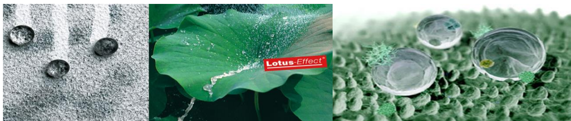
Рис. 1. Природний «лотос – ефект», втілений німецькою компанією Sto у екстер'єрній фарбі «Lotusan» [13]
