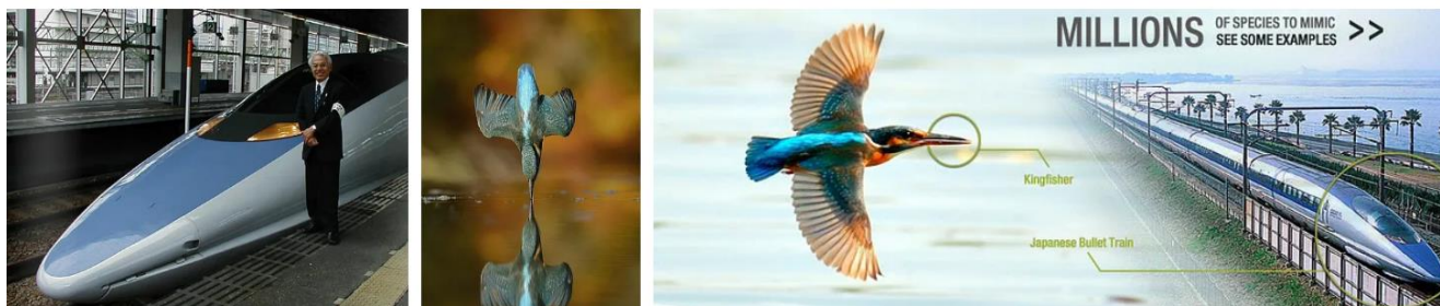
Рис. 3. Аеродинаміка обтічного дизайну вдосконаленого японського високошвидкісного поїзда Shinkansen Series 500 була змодельована за дзьобом птаха зимородка [17]
