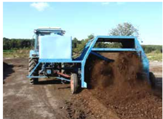
Рис. 1. Змішувач-аератор в роботі
