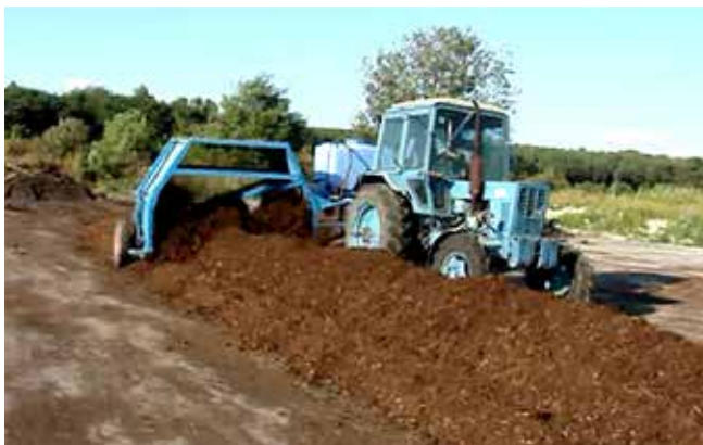
Рис. 1. Змішувач-аератор в роботі
