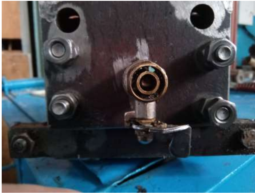
Рисунок 3.10 – Загальний вигляд знімної вставки каналу з напівповоротним краном
