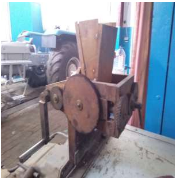
Рисунок 1.8 – Однопарні плющильні вальці: а – вид з боку; б – вид зверху
