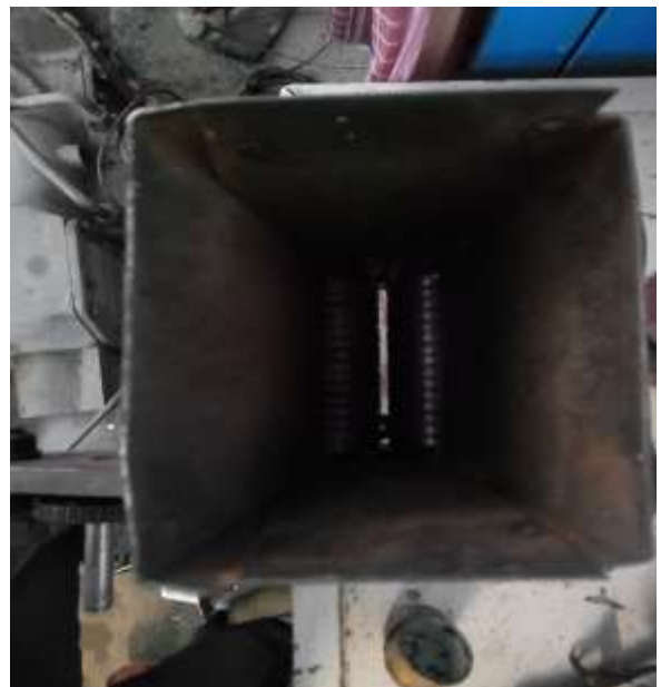
Рисунок 1.8 – Однопарні плющильні вальці: а – вид з боку; б – вид зверху
