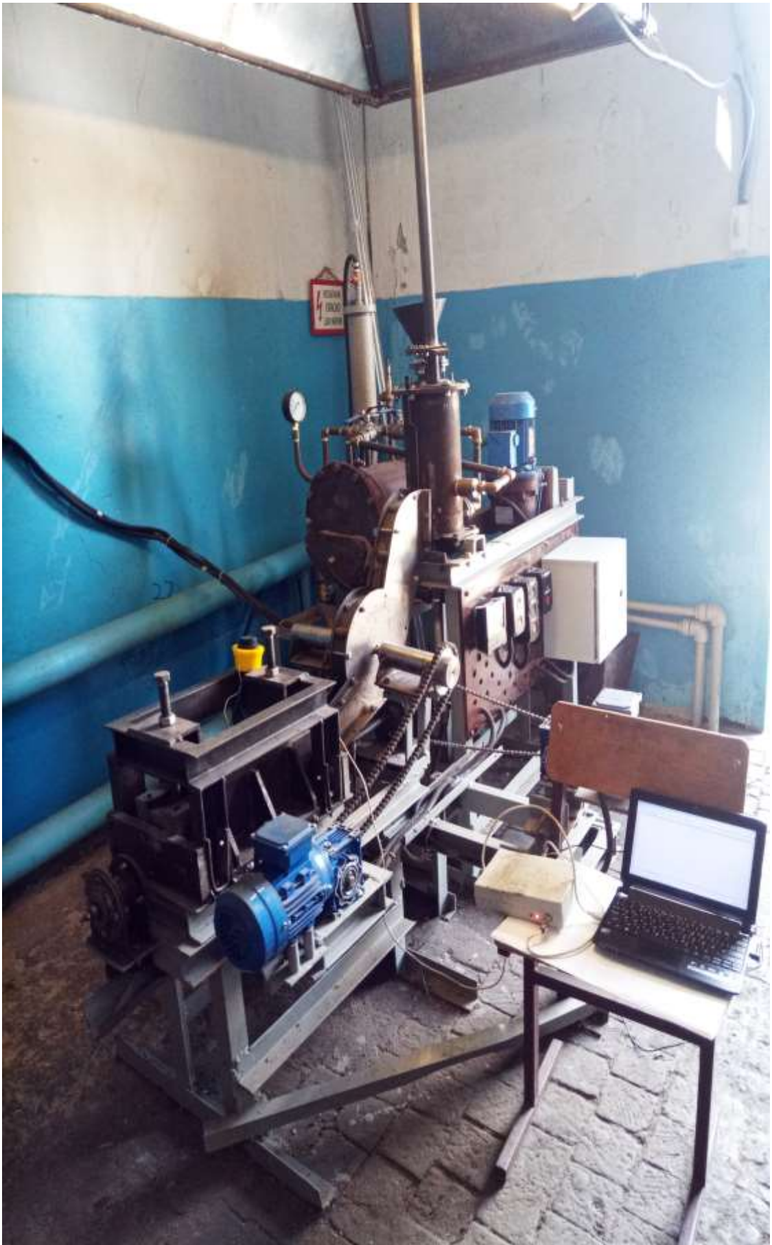
Рисунок 3.4 – Загальний вид експериментального комплексу для віджимання олії з олійної сировини
