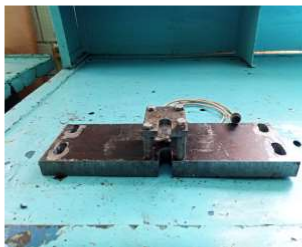
Рисунок 3.14 – Загальний вигляд плити з тензобалкою
