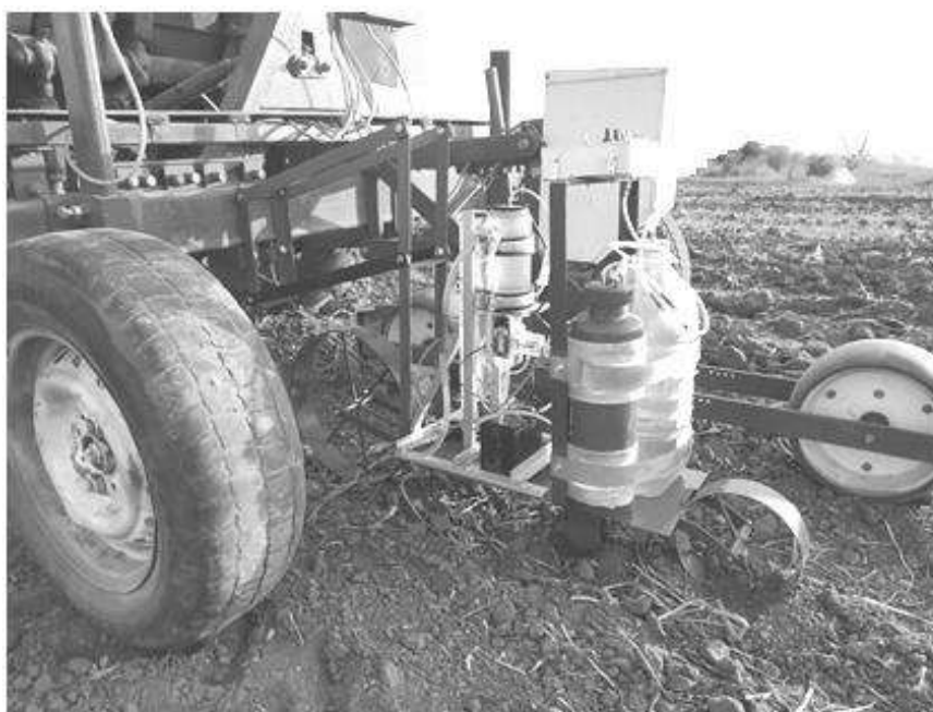
Рис. 3.22. Експериментальна сівалка з гідропневматичним апаратом точного висіву пророслого насіння овочевих культур
