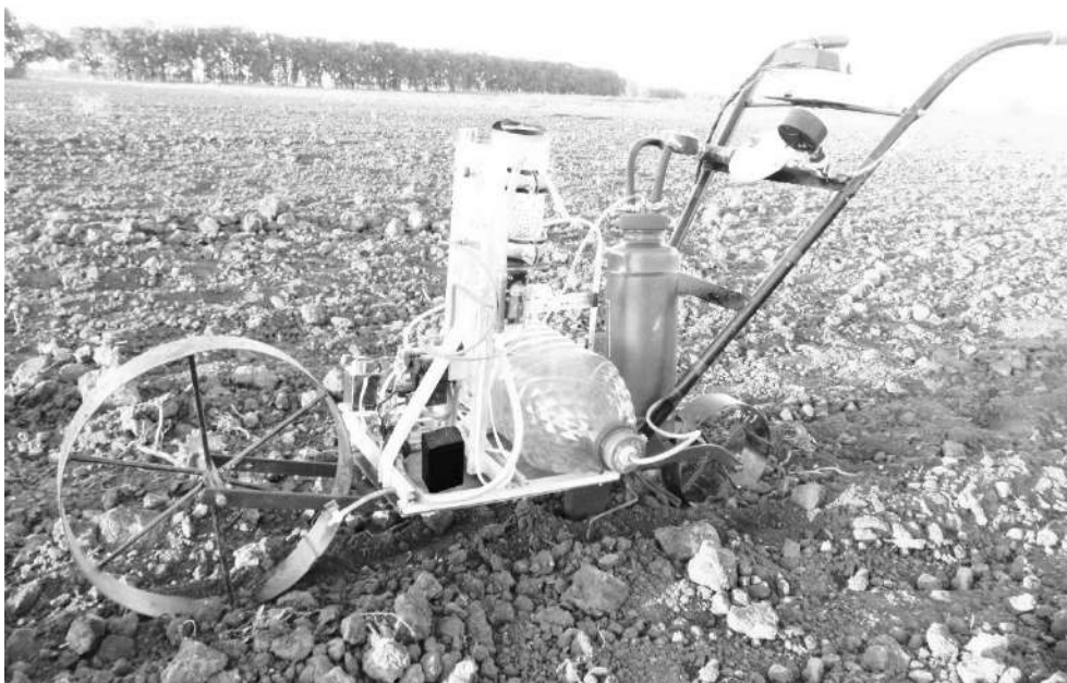
Рис. 3.5. Загальний вигляд експериментальної гідропневматичної сівалки точного висіву
