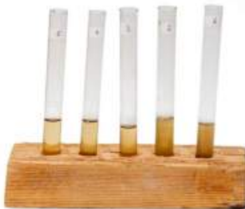
Рис. 4.30 Прозорість очищеної рицинової олії в залежності від часу витримки 1 – віджата олія; 2 – гідратована віджата олія; 3,4,5 – олія після витримки в електрофлотаційній камері відповідно 300 с, 600 с та 1000 с
