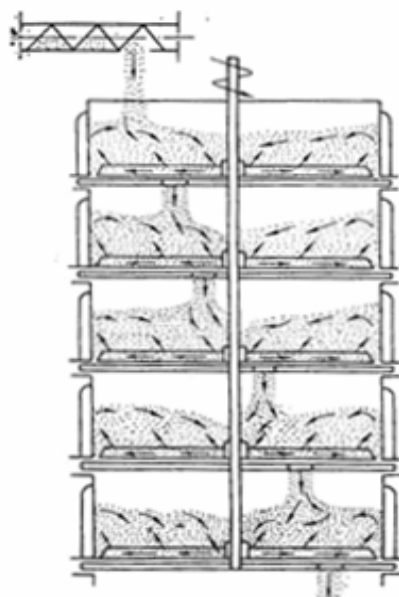
Рис. 2.1. Схема руху частинок м'ятки в жаровні при потоковому, безперервному жарінні
