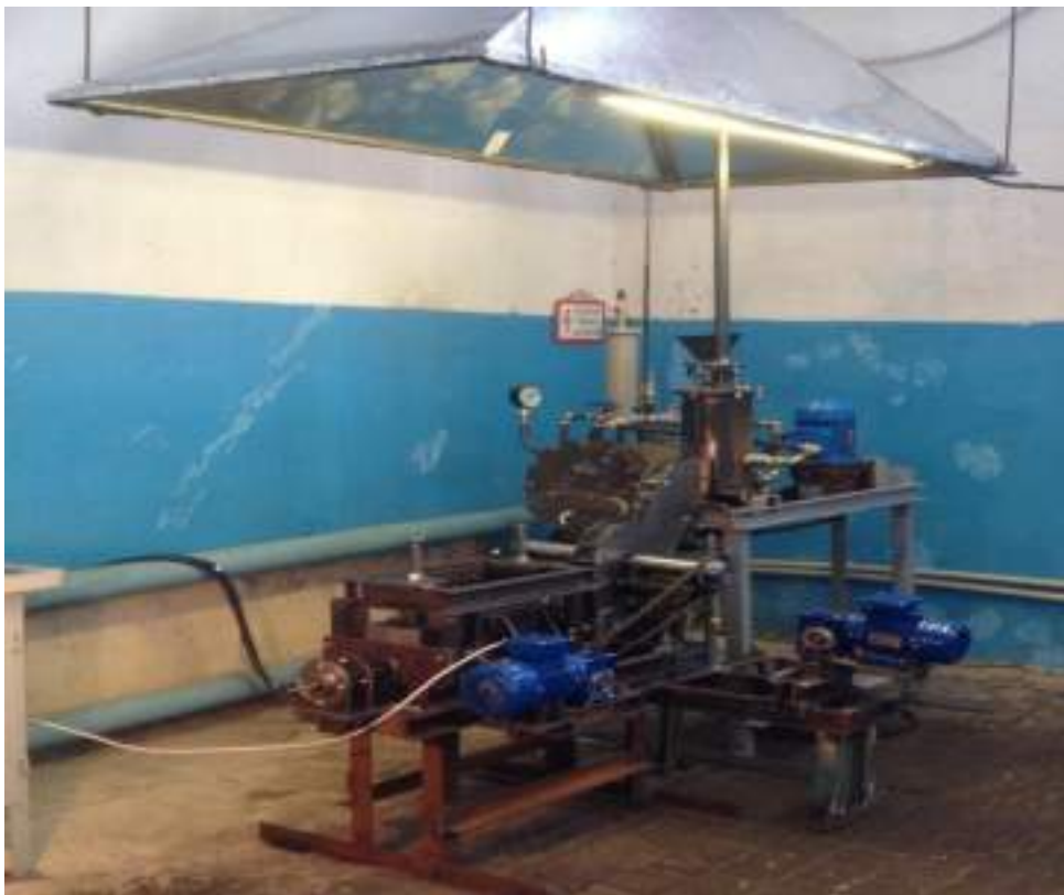
Рис. 3.4. Загальний вигляд експериментального комплексу для волого-теплової обробки м'ятки і віджиму олії з олійної сировини
