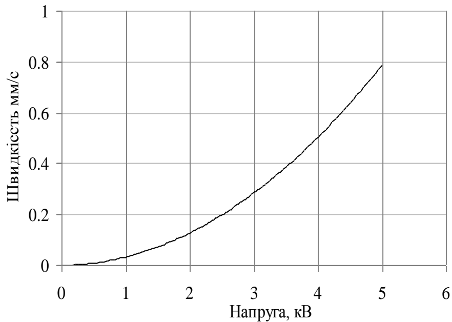
Рис. 2.24. Залежність швидкості частинки в момент стикання з електродом від напруги
