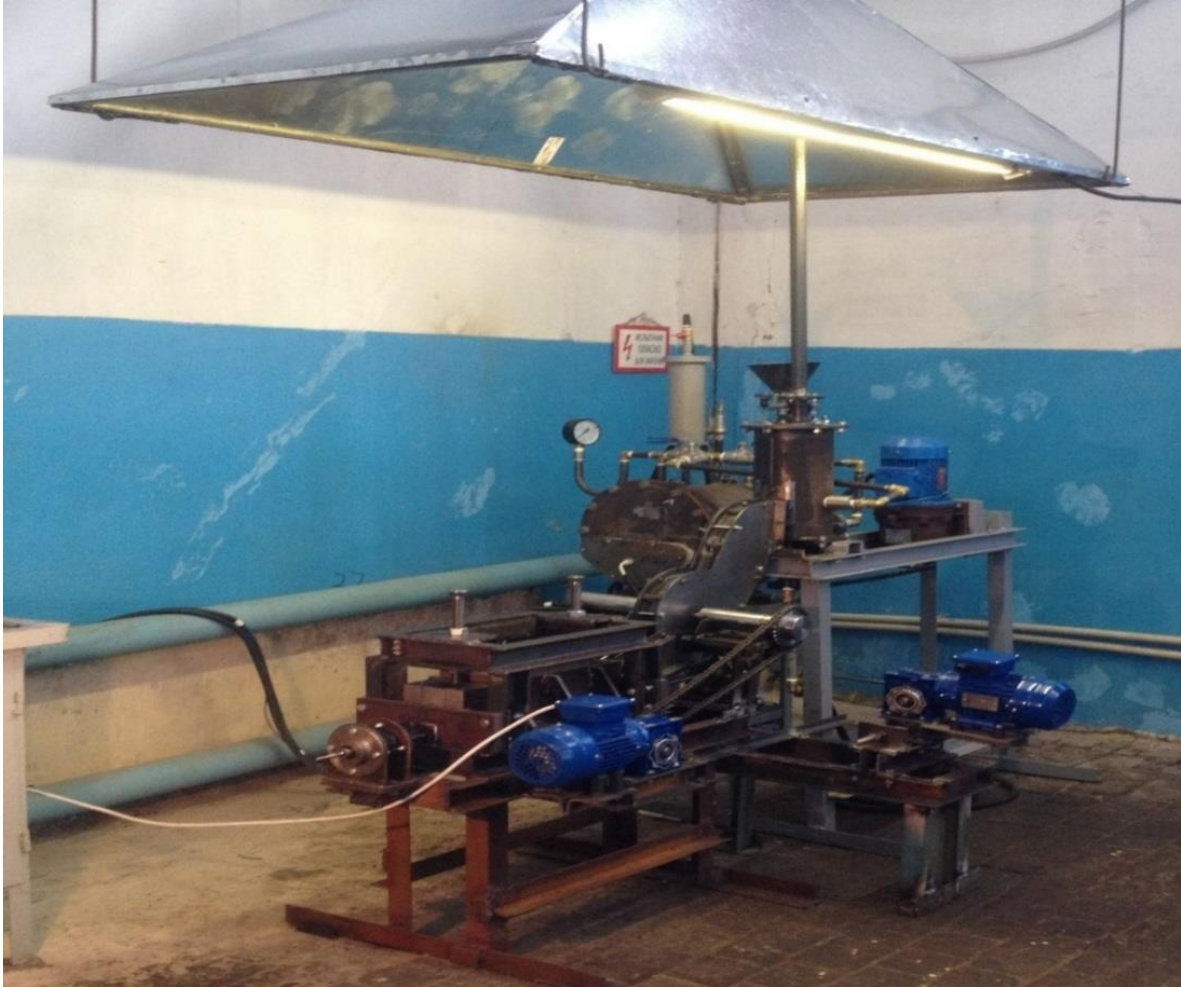
Рис. 10. Загальний вигляд експериментального комплексу для волого-теплової обробки м'ятки і віджиму олії з олійної сировини
