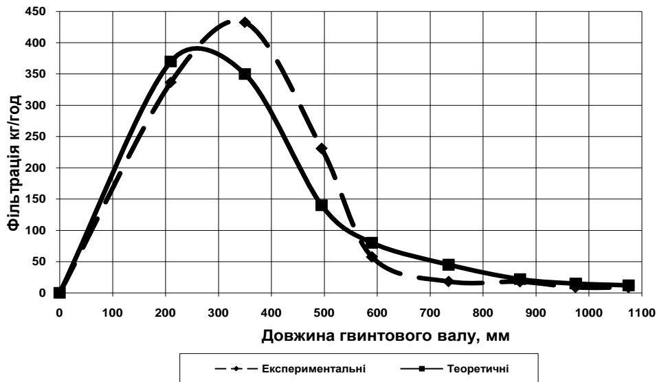
Рис. 17. Результати порівняння теоретичних і експериментальних досліджень фільтрації олії по довжині гвинтового вала преса ФП
