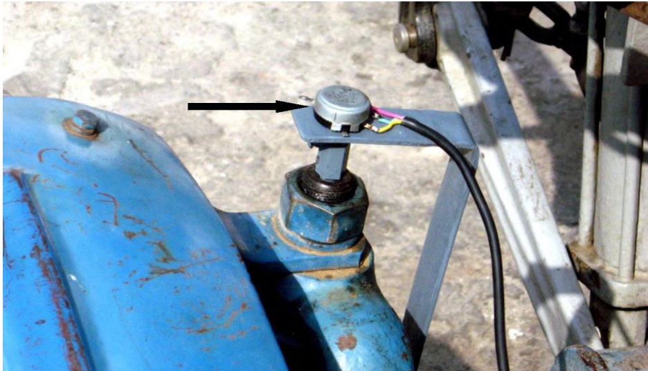
Рисунок 3 .9 – Установка датчика для реєстрації кута повороту керованих коліс енергетичного модуля МЕЗ
