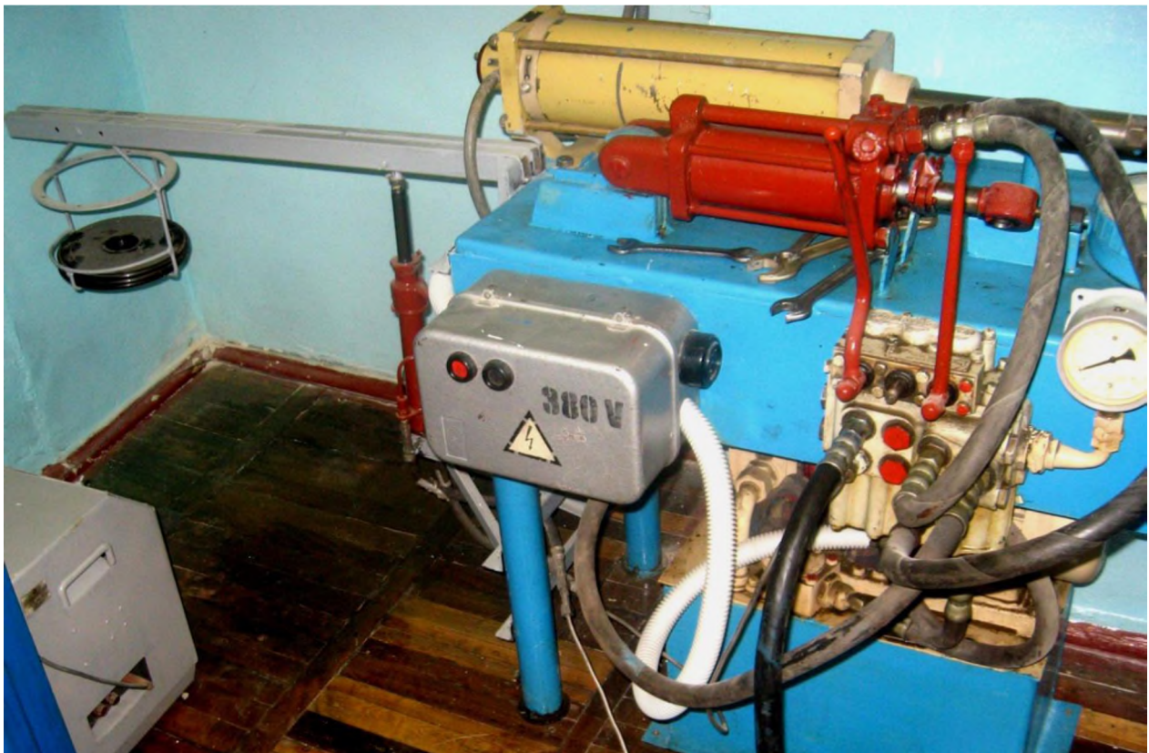
Рисунок 3.4 – Лабораторна установка для визначення впливу діаметру отвору демпферна шайби на коефіцієнт її гідравлічного опору
