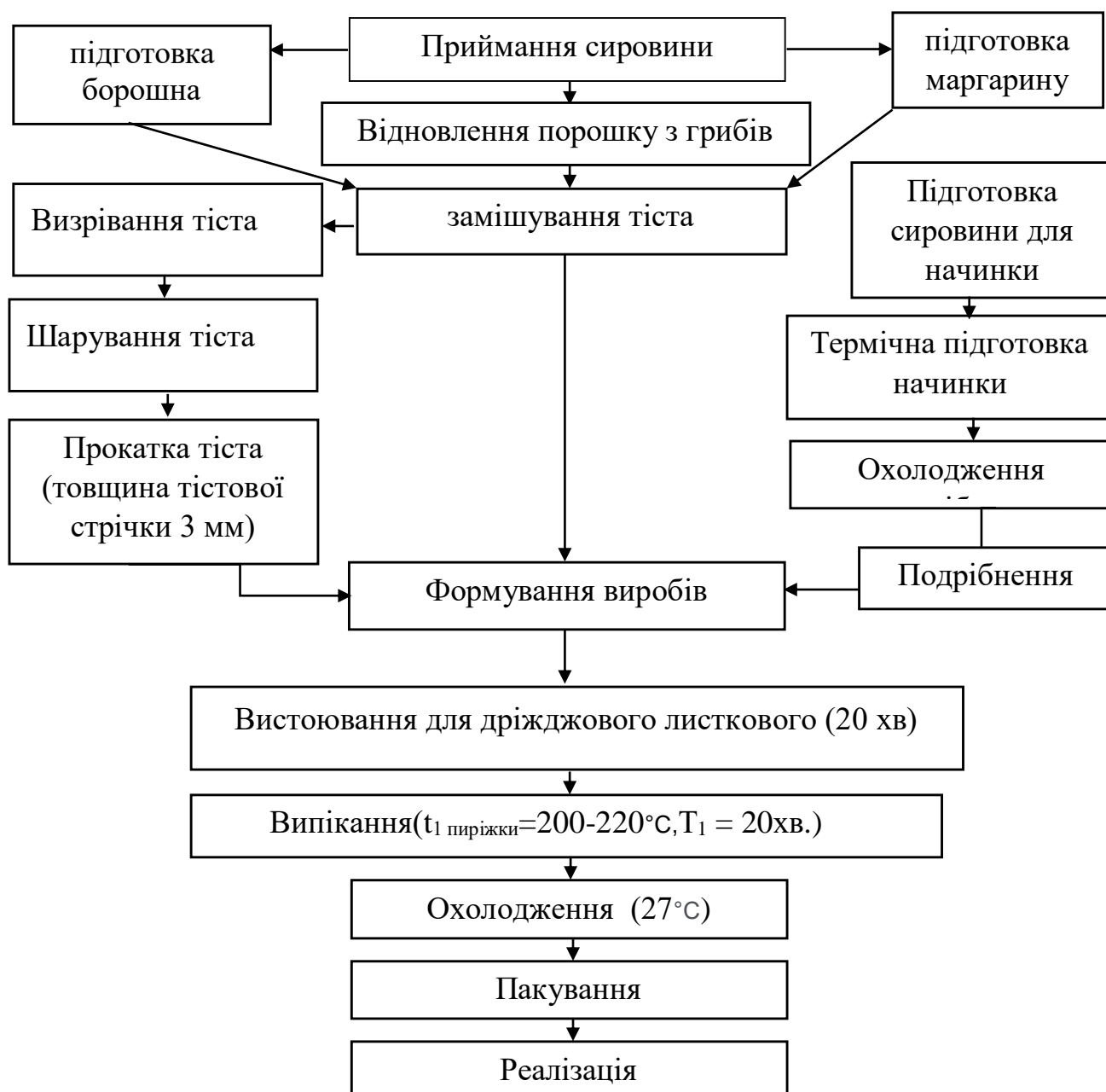
Рис. 4.1. Схема технологічних етапів виготовлення випічки з листкового тіста
