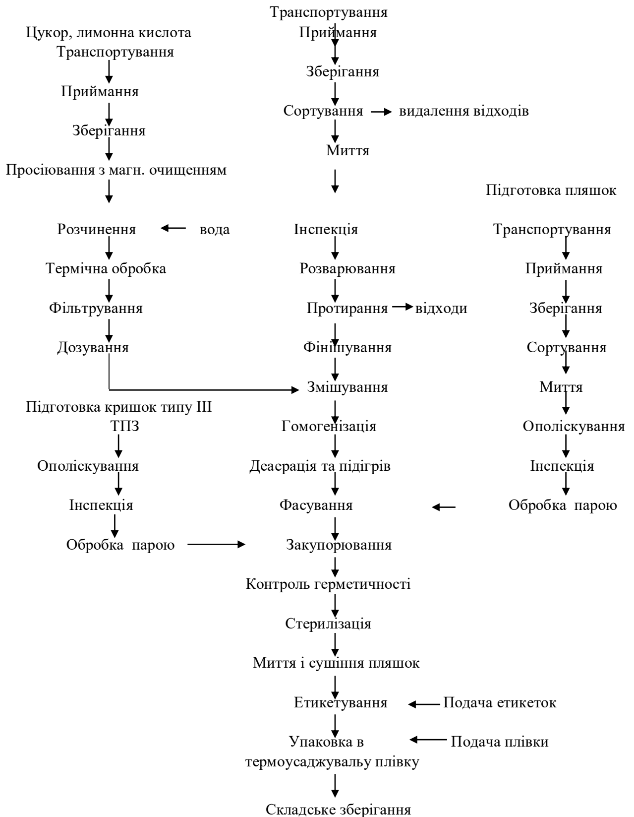
Рисунок 3.1. Технологічна схема виробництва фруктових соків.
