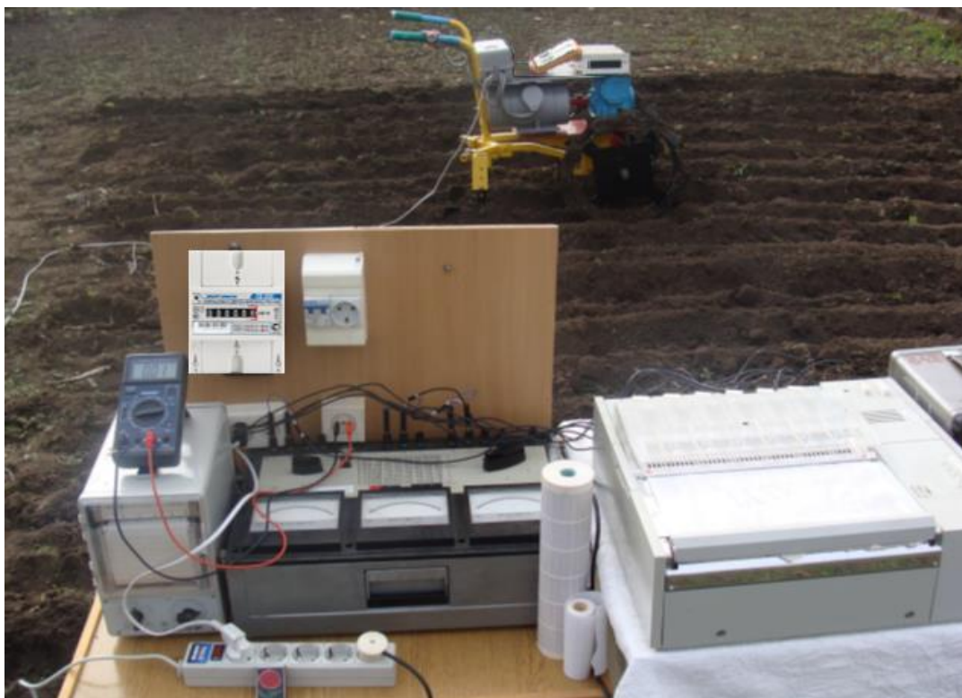
Рисунок 4.6 - Польові випробування електромоблока
