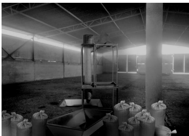
Рисунок 39 – Віброаспіраційний сепаратор ВАС–7 під час сепарації насіння соняшнику в СФГ “ВІТА”
