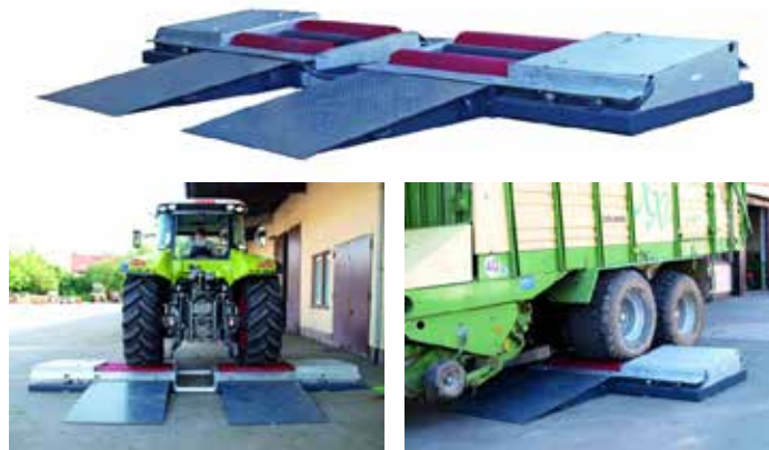
Рис. 2. Силовий роликівий гальмівний стенд для мобільних енергетичних засобів
