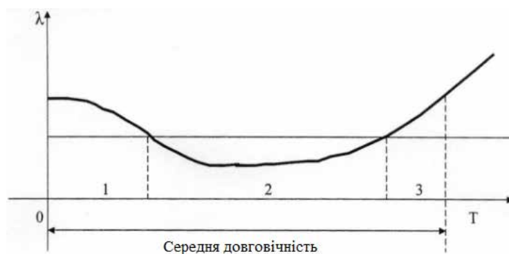
Рис. 1. Графік кривої залежності інтенсивності відмов елементів зрошувальної системи від часу.
