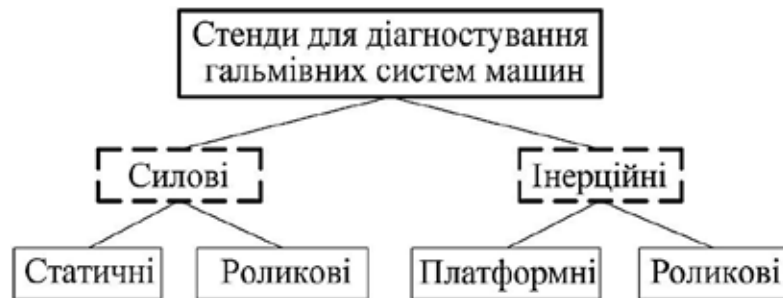
Рис. 1. Класифікація стендів для контролю технічного стану гальмівних систем мобільних енергетичних засобів
