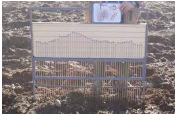
Рис. 4. Приклад застосування штир'ювого профілометра для визначення мікрорельєфу ділянки поля.
