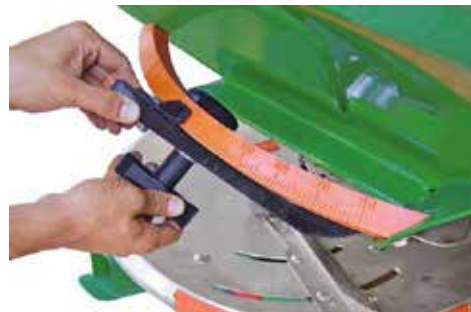
Рис. 2. Механізм для налаштування норми внесення добрив
