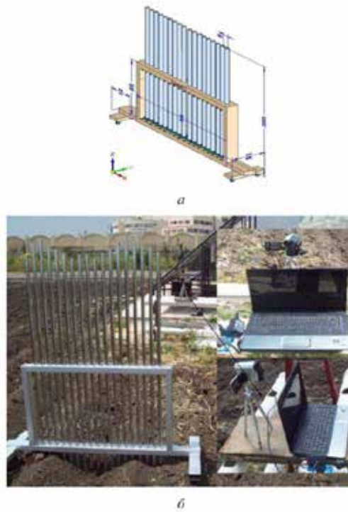
Рис. 5. Вимірювач профілю ґрунту: а – схема в аксонометрії; б – у процесі заміру.
