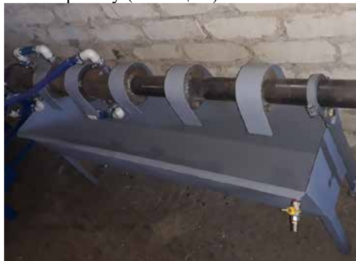
Рис. 1. фрагмент робочих органів, до складу якого увійшов розроблений орган остаточного формування брикету з системою відбору технічних олій
