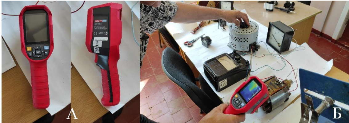
Рис. 1. Схема проведення експерименту: А – тепловізор UTi165A; Б – методика
