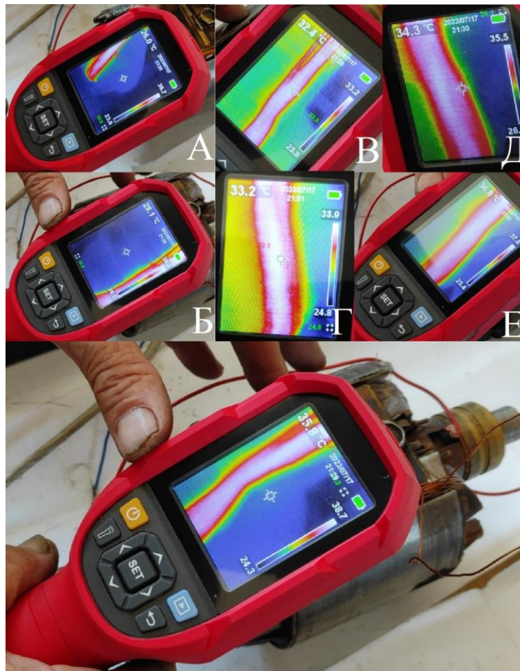
Рис. 5. Зміна температури обмотки. А, Б – виміри робочої обмотки; В, Г, Д, Е – короткозамкнена обмотка (32,4; 33,2; 34,3; 36,8°C відповідно)
