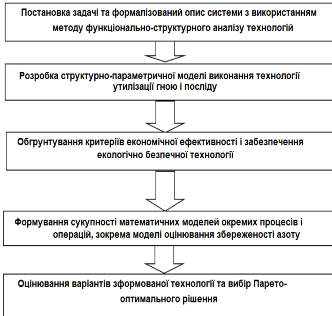
Рис. 4. Основні блоки методу проєктування технологій утилізації гною та посліду
