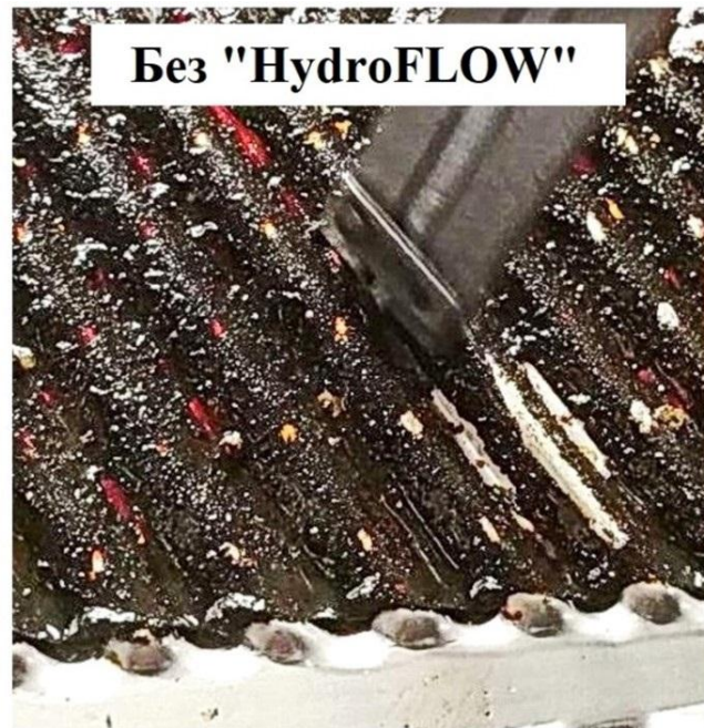
Рис. 3. Порівняння стану пластин теплообмінного апарату до та після випробування приладу "HydroFLOW" [5].
