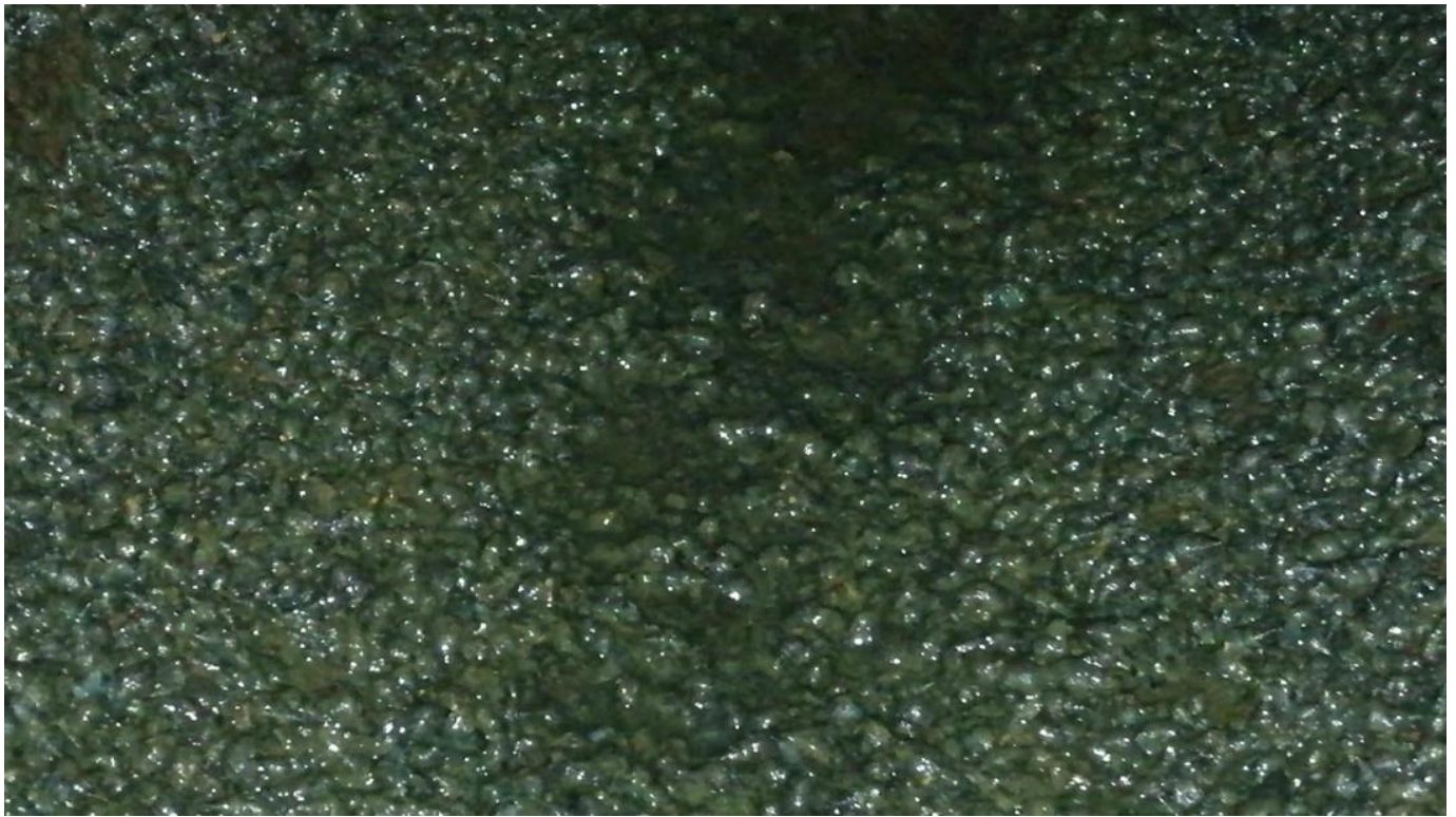
Рис. 1. Популяція молюсків сімейства Thiaridae на внутрішній поверхні сітки фільтру насосного агрегату ВП ЗАЕС
