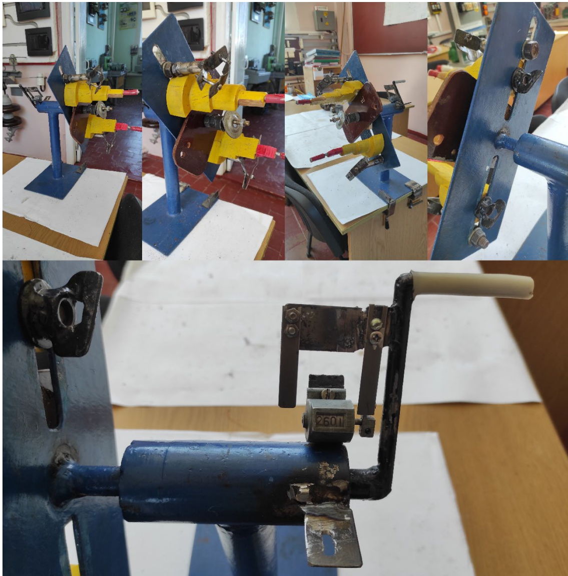
Рисунок 4. Пристрій намотування обмоток електродвигуна
