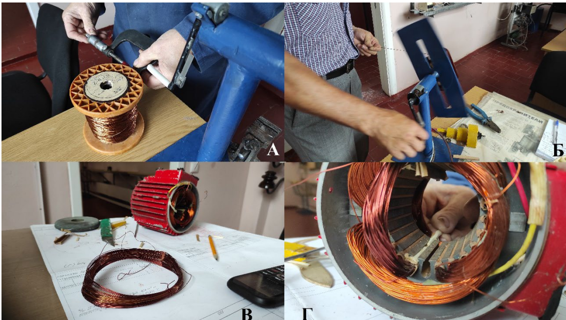
1 – визначення діаметру проводу; 2 – намотування котушки; 3 – підготовка до встановлення котушки; 4 – установка котушки Рисунок 3. Ремонт електродвигуна у лабораторних умовах.
