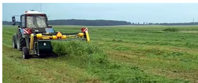
Рис. 3. Устройство УПВТ-4,0 при выполнении технологического процесса вспушивания злаковых трав
