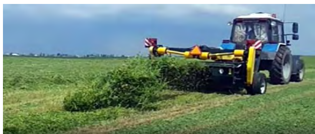
Рис. 2. Устройство УПВТ-4,0 при выполнении технологического процесса плющения бобовых трав
