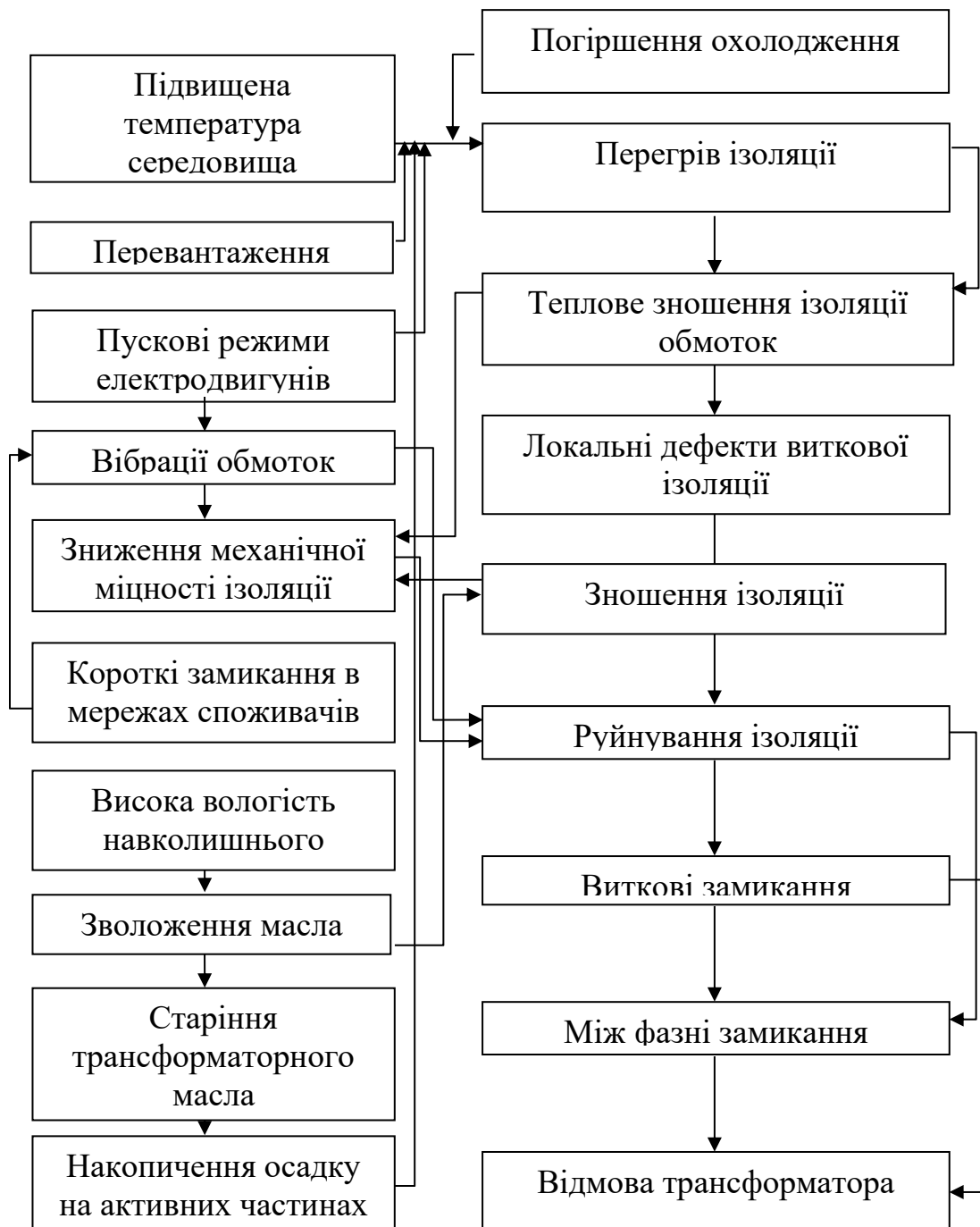
Рисунок 1 – Блок-схема пошкоджень елементів конструкції силових трансформаторів
