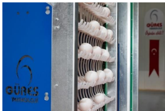
Рисунок 5. Система збору яєць «Водоспад» «Гюрес Текноложи»
