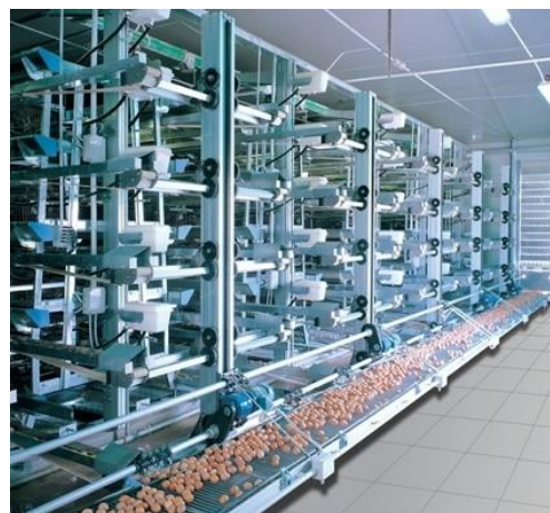
Рисунок 3. Ліфтова система збору яєць «Анаконда»
