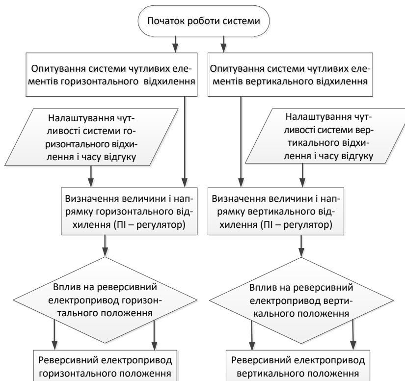
Рисунок 1. Алгоритм регулювання електроприводу орієнтування сонячних панелей
