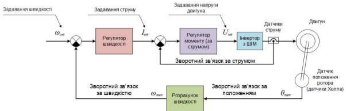
Рисунок 2. Схема керування BLDC-двигуном
