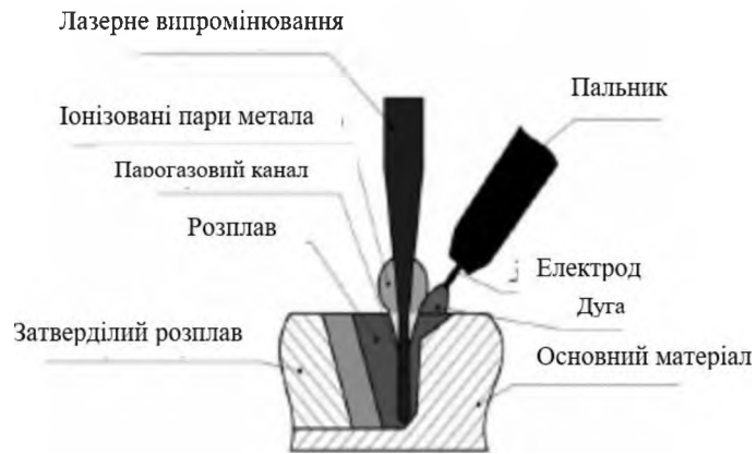
Рисунок 1 – Схема лазерно-дугового зварювання
