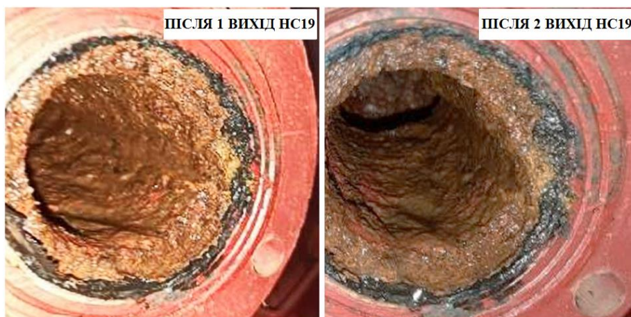
Рисунок 3. Стан насічки на відкладеннях на фланці з боку входу води до системи водоохолодження електродвигуна НС19 після випробувань у двох ракурсах (Ліворуч - ракурс 1, Праворуч - ракурс 2).
