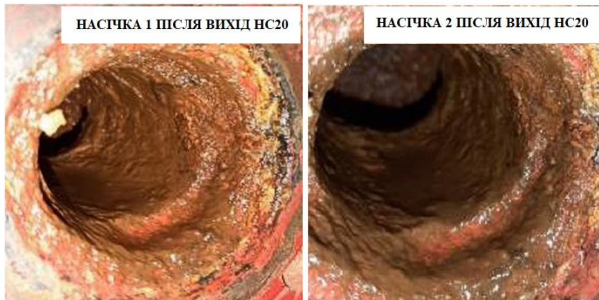
Рисунок 8. Стан насічки на відкладеннях на фланці з боку входу води до системи водоохолодження електродвигуна НС20 після випробувань в двох ракурсах (Ліворуч - ракурс 1, Праворуч - ракурс 2).
