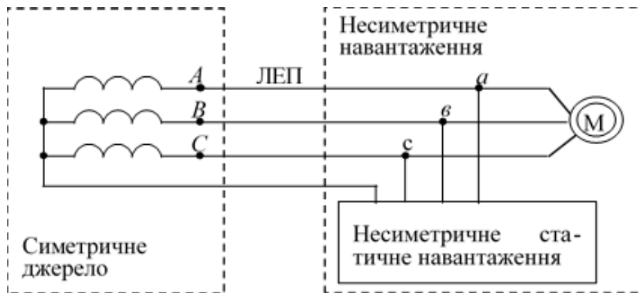
Рисунок 1. Принципова схема трифазного кола з несиметричним навантаженням
